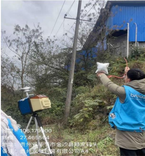
图 5-2 无组织废气采样图
