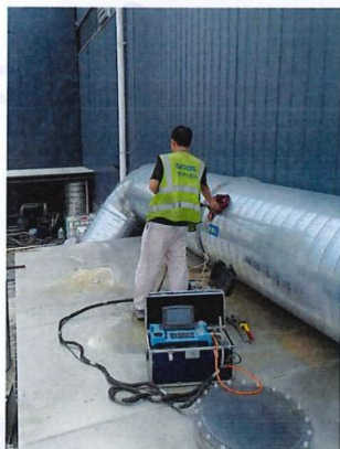
DA002 环保机废气处理前采样口
