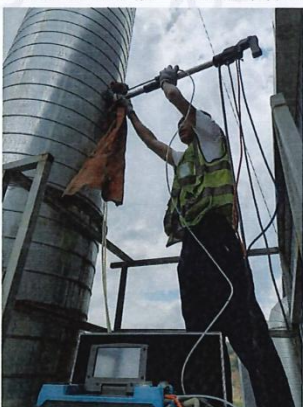
DA002 环保机废气处理后采样口
