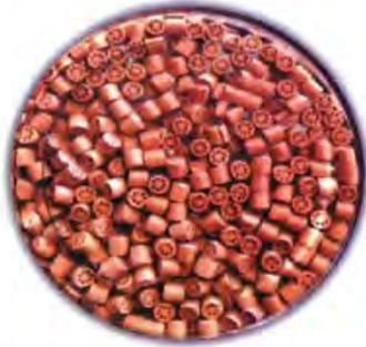
图 9.2-4 新型大孔树脂吸附材料
