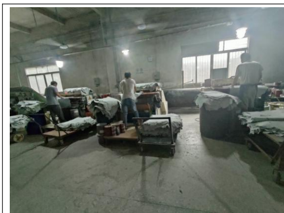
1 生产车间削匀工序
