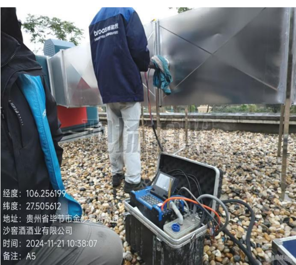
图 6-3 有组织废气采样图
